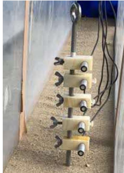
図 8. 飛砂量の垂直分布の計測装置。
