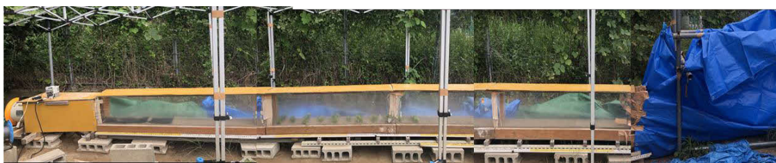
図 6. 風洞実験装置の全景. 左が上流側で、風洞中央部に植生域が見える。
